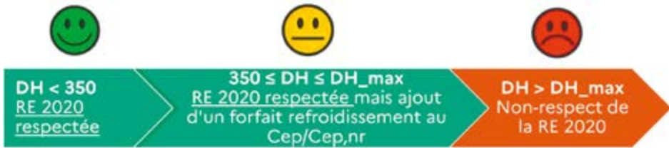
Figure D 1 : Schéma de principe du calcul du confort d'été selon la RE2020.
